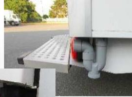
4 bondes d'écoulement :
