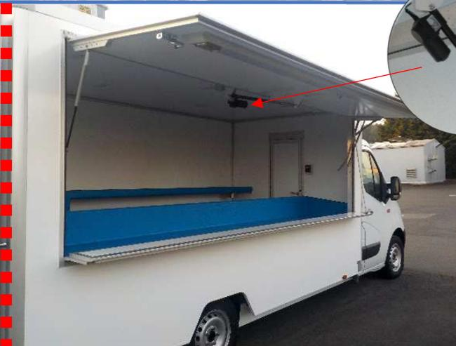
Auvent et tablette, relevable par compas à gaz et vérin électrique central - Profil tablette spécial pour blocage à 90°
