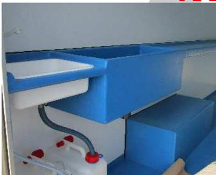
Table côté gauche sur la longueur, avec lavabo plastique (+ 2 jerricans, bec verseur et pompe immergée 12V), bac à moules
