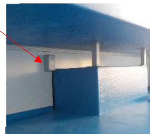
12 v Steckdose unter der Wanne hinter der Klappe (Waage Anschließung)
