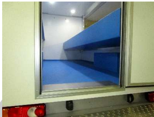
Boden mit glatte Kunststoffoberfläche und 200mm Stahlblech
