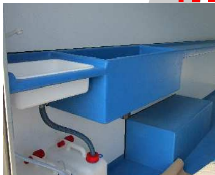
Tisch auf der ganzen linken Seite, mit Waschbecken aus GFK (+ 2 Tank, Ausgießer und 12V Unterwasserpumpe), und Becken für Muscheln
