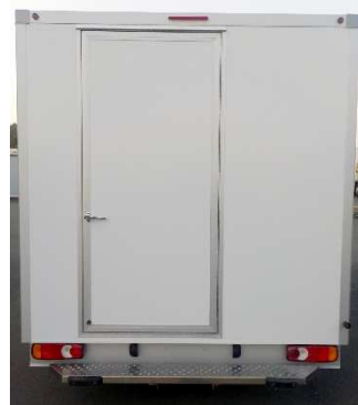
Außer mittige Hecktür mit verschließbare Innen / Außengriffe, und 180° magnetische Türfeststeller
