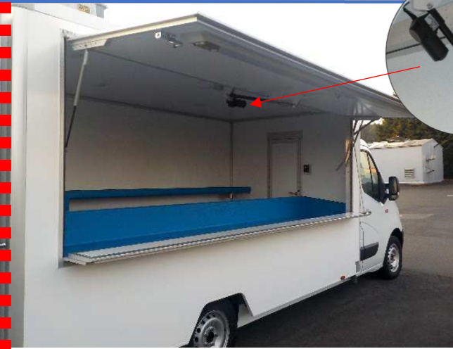
Verkaufsklappe und -brett, Öffnung durch Gasfedern und mittigen Elektrozyylinder – Sonder Profil für Brett, 90° Blockierung
